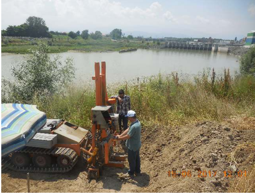
Şekil 4. Çalışma alanında yürütülen CPT çalışmalarından bir görüntü
